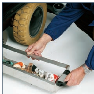
SWEEPING SYSTEM WITH 865 mm ROLLER DIE WALZEN DES BÜRSTAGGREGATES HABEN EINEN DURCHMESSER VON 865 mm VEEGSYSTEEM MET EEN WALSBORSTEL VAN 865 mm METRO 1102N
